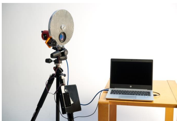
obr. 6-4 Zásobník optických filtrů s kamerou ZWO ASI 1600 MM a objektivem Zeiss Interlock Compact [62].
